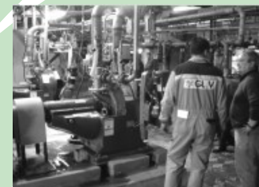
Мельницы для размолва целлюлозы на НЦБК NPPM mills for pulp grinding.
